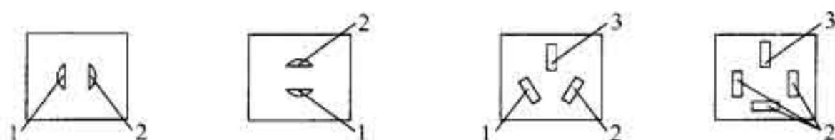
图3 面对插座接线
